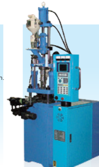
■ 拉鏈機 Zipper machine 自動送帶、收帶上下一次為一次成型 Automatic strap feeding and take-up for one-time injection
